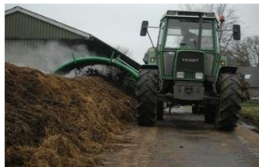
Het omzetten met een getrokken omzetmachine
